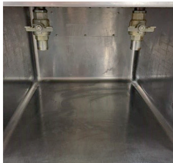
Abb. 7 und 8 Fritteuse mit verdeckter Anbringung der Fettablassvorrichtung
